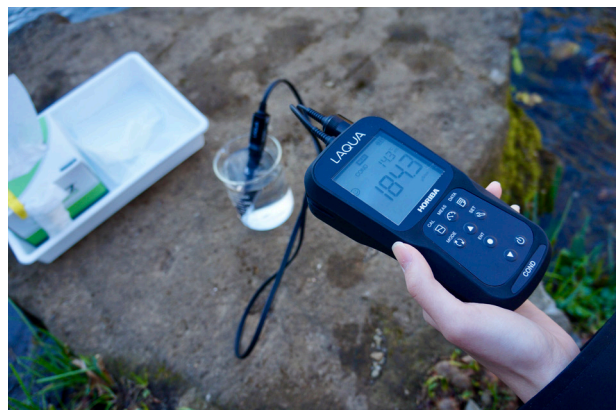
電気伝導度の測定
